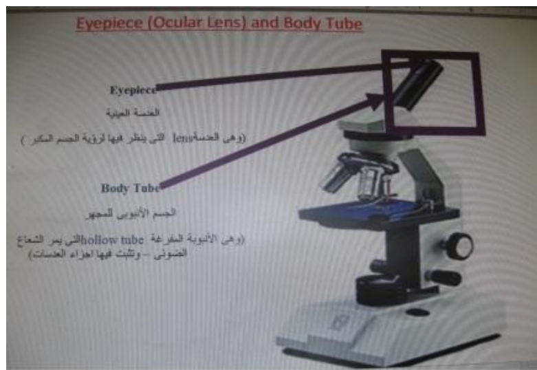
العدسة العينية & الجسم الأنبوبي للمجهر Eyepiece (Ocular Lens) and Body Tube
