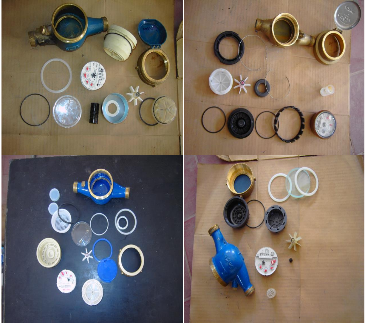
صورة الأجزاء الداخلية لعدادات المياه المنزلية
