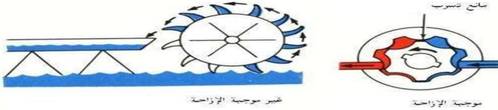
الأزاحة فى الدائرة الهيدروليكية هو حجم الزيت الذى تحرك أو تمت ازاحته بأستخدام المضخه فى كل دورة وبالتالي تنقسم المضخات الهيدروليكية إلى:
