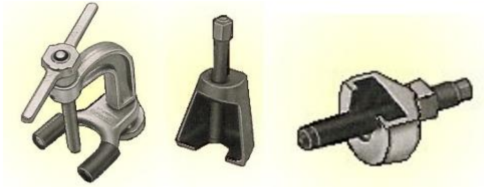
الشكل (1-26) يبين الزرجينات الخاصة بفك وتركيب الوصلات المفصلية
