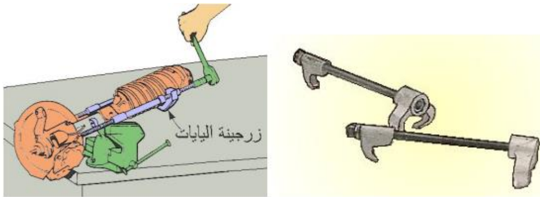
الشكل (1-27) يبين الزرجينات الخاصة بفك وتركيب اليايات
