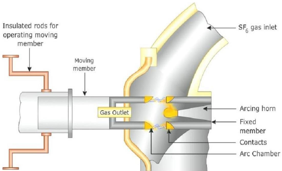
يستخدم غاز سادس فلوريد الكبريت كوسط لإطفاء الشرارة أو القوس الكهربى ويستخدم كوسط عازل -
