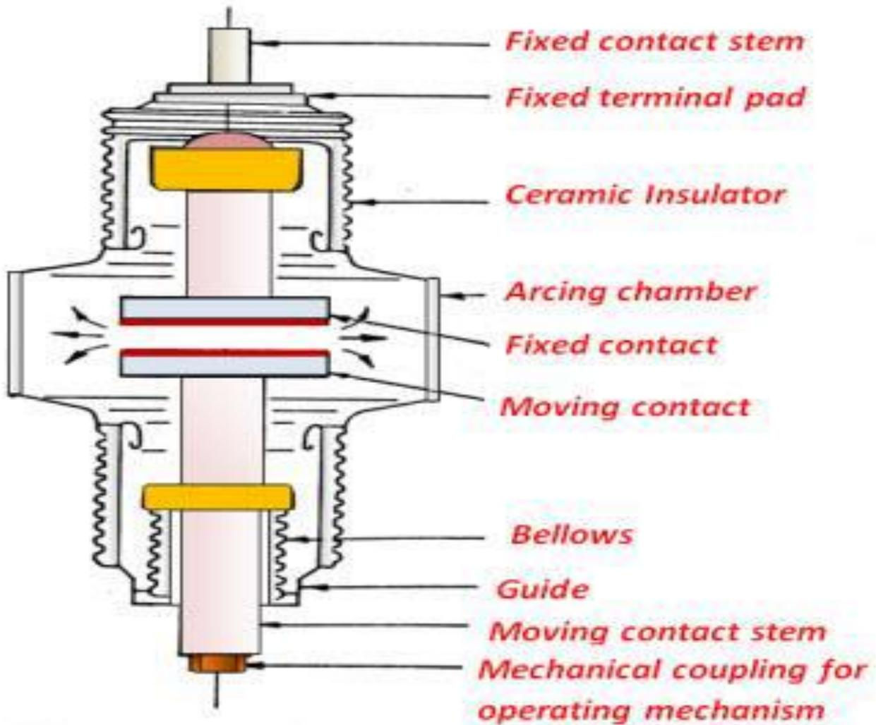
شكل "4" قاطع مفرغ من الهواء " طراز اجيماك "
