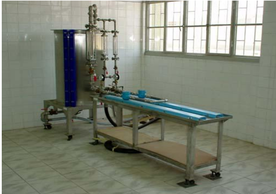
شكل (7) جهاز معايرة عدادات المياه المنزلية
