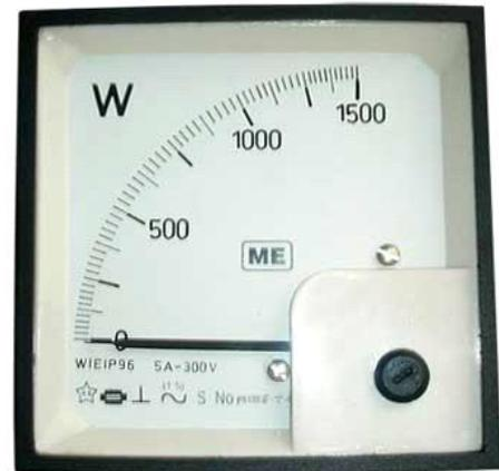
يستخدم هذا الجهاز لقياس قدرة الاحمال الكهربائية ويحتوي من الداخل على ملفين أحدهما يسمى بملف التيار ويوصل مع الحمل على التوالي والاخر يسمى ملف الجهد ويوصل مع الحمل على التوازي، يوصل هذا الجهاز مع الحمل مع مرعاه سريان التيار في الدارة أي ان الدارة مغلقة.
