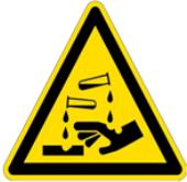
عند تفاعل الكلور مع الماء أو الرطوبة الجوية تتكون الحوامض التي تسبب التآكل للمعادن لذلك يجب أن يبقى الكلور ومعدات الكلور بعيداً عن الماء والرطوبة الجوية.
