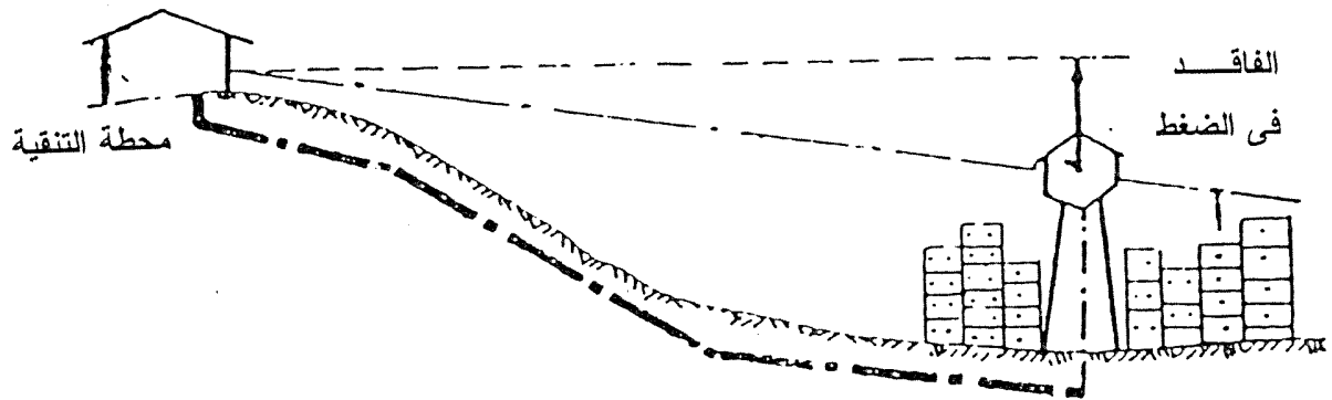
شكل رقم (1-21): فاقد الإحتكاك في المواسير يساوي الفاقد بين المنسوبين (محطة التنقية والخزان)
