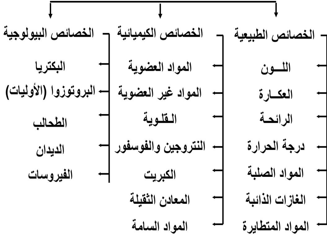
شكل رقم (3) مخطط لخصائص مياه الصرف الصحي
