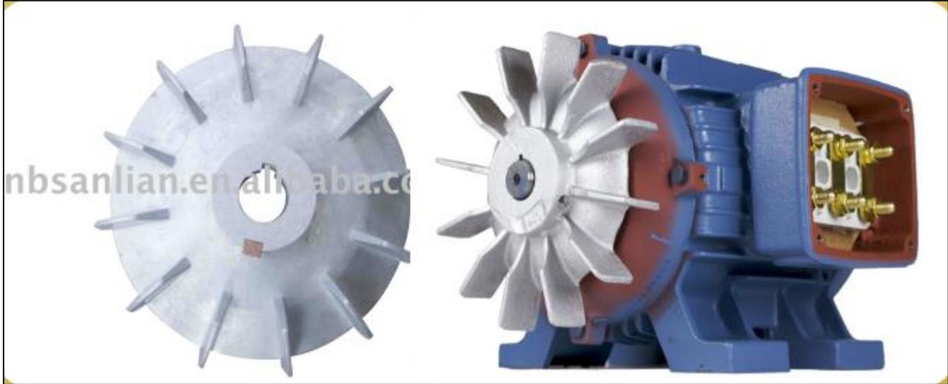
الإطار فتخفف من درجة الحرارة التي تنشأ عن مرور التيار في ملفات القلب الحديدي للعضو الثابت.
