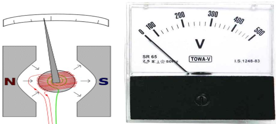
يستخدم هذا الجهاز لقياس فرق الجهد المطبق بين طرفين حمل كهربائي ما أو لقياس جهد المصدر، يوصل هذا الجهاز على التوازي مع المصدر أو الحمل الكهربائي مع شرط سريان التيار الكهربائي أي يجب أن تكون الدارة الكهربائية المراد قياس فولتيتها مغلقة. ويتم توصيله مباشرة عن طريق مفتاح اختياري في لوحات الجهد المنخفض اما في لوحات الجهد المتوسط او العالي فيتم توصيله عن طريق محول جهد الخرج له 110ف
