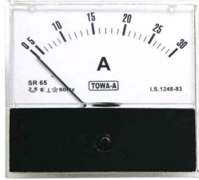
يستخدم هذا الجهاز لقياس التيار الكهربائي المار في حمل كهربائي ما ، يوصل هذا الجهاز مع الحمل المراد قياس تياره على التوالي مع مراعاة ان تكون الدارة الكهربائية مغلقة ،ومنها ما هو رقمي او بمؤشر وفي الاحمال العالية يوصل كل اميتر عن طريق محول تيار ويذكر نسبة التحويل لمحول التيار المستخدم اسفل المؤشر اما الرقمي فيتم برمجته بنسبة التحويل لمحول التيار
