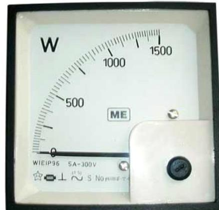
يستخدم هذا الجهاز لقياس قدرة الاحمال الكهربائية ويحتوي من الداخل على ملفين أحدهما يسمى بملف التيار ويوصل مع الحمل على التوالي والآخر يسمى ملف الجهد ويوصل مع الحمل على التوازي، يوصل هذا الجهاز مع الحمل مع مرعاه سريان التيار في الدارة أي ان الدارة مغلقة.
