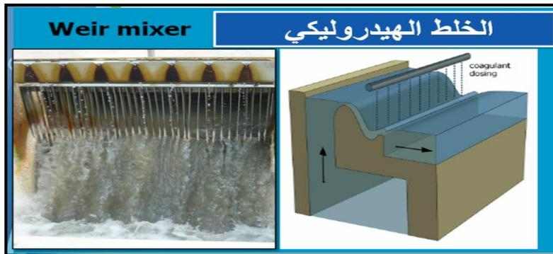
شكل (6) الخلط الهيدروليكي
