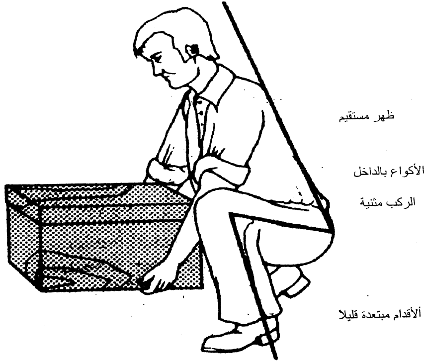
شكل رقم (٢-١): وضع صحيح لرفع الأحمال من الأرضية
