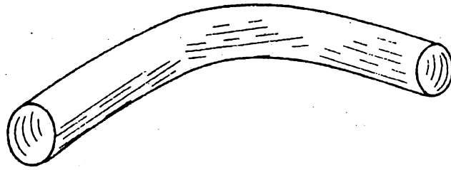
وصلة كوع ٩٠ درجة بدون فتحة للتفتيش
