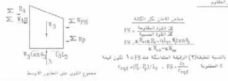
شكل رقم (8-37) طريقة تحليل الإنهيار الإنتقالي
