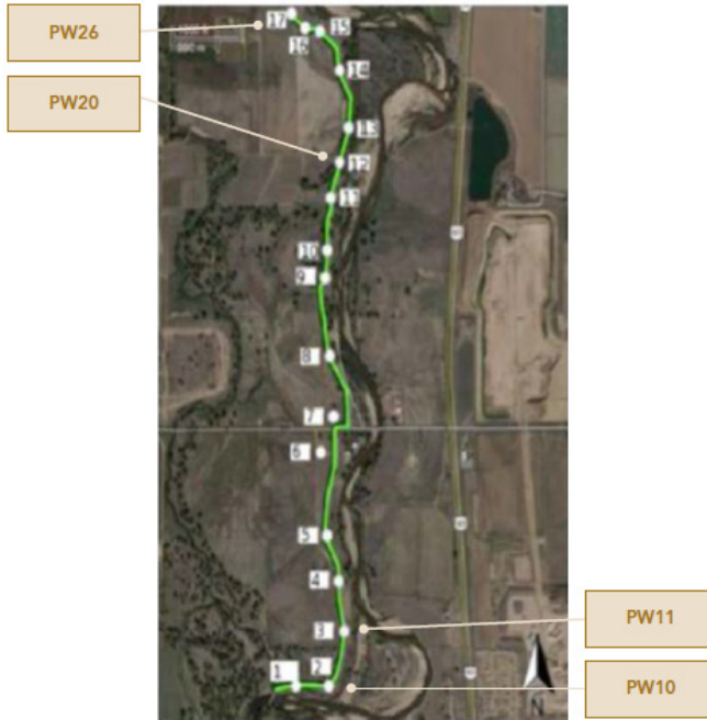
الشكل (1) : خريطة جوية لحقل آبار الترشيح في ضفاف النهر على طول نهر بلات الجنوبي في برايتون Brighton بولاية كولورادو Colorado التي تبين مواقع الآبار التي تم أخذ عينات منها (PW: بئر الإنتاج) (Drewes et al. 2015).
